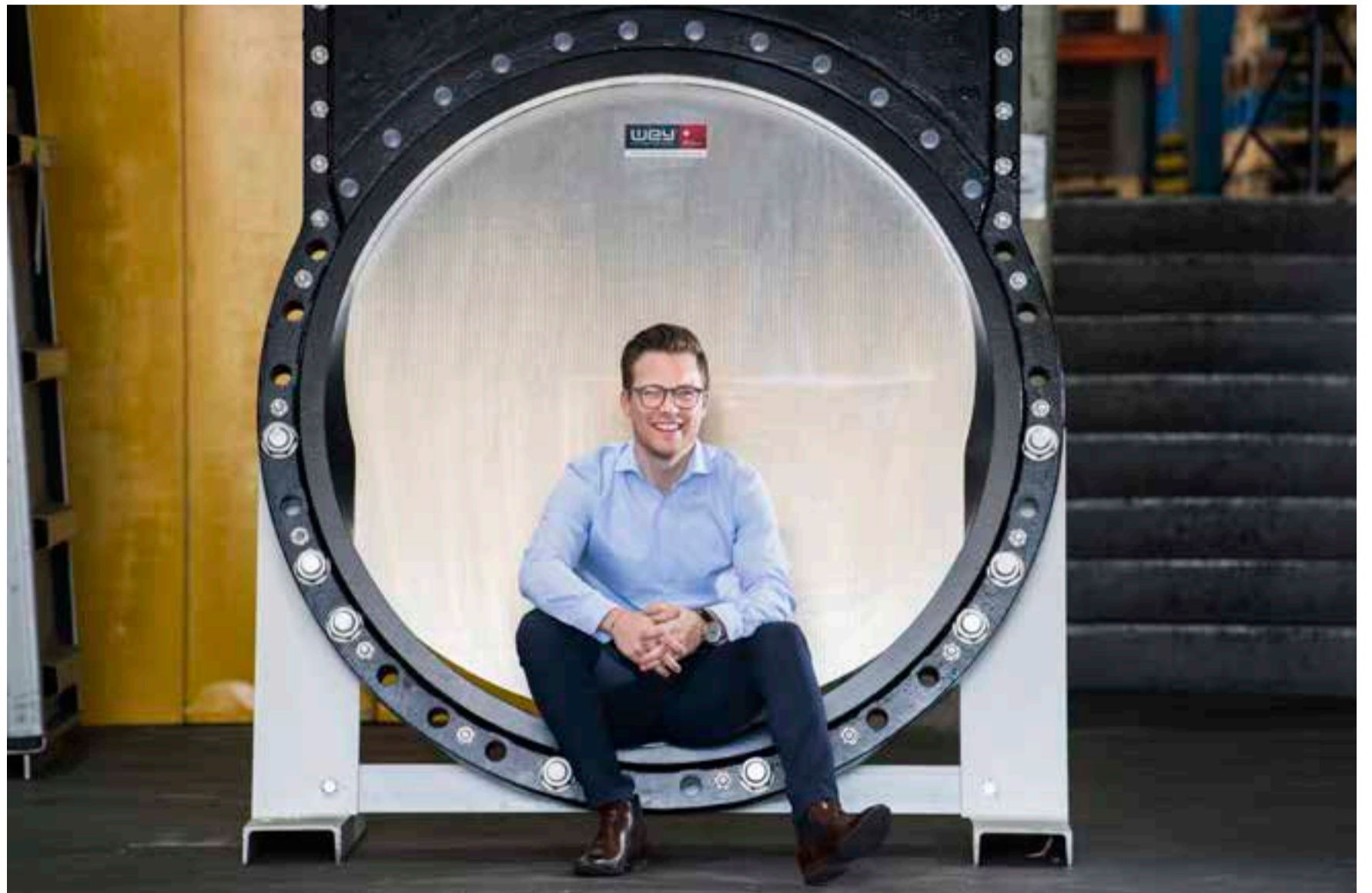
Sie haben einen (Rohr-)Durchmesser von 50 bis 2000 Millimeter: Die Wey Plattenschieber der Sistag AG werden in Eschenbach hergestellt und in alle Welt exportiert. Darauf ist Geschäftsführer Samuel Sidler besonders stolz. «Wir sind und bleiben ein Schweizer Unternehmen mit allem, was dazu gehört.»
